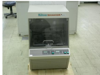
انکوباتور شیکردار ( گرمخانه گذاری محیط کشت به منظور رشد میکرو ارگانیسم )
