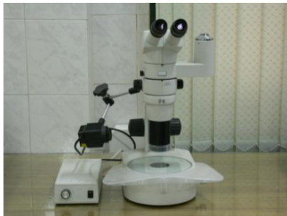
لوپ ( استریو میکروسکوپ دوربین دار ) جهت بررسی موجودات ماکروسکوپی و ثبت اسلاید
